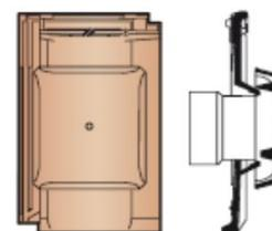
Проходной комплект для вентиляции (D=150мм)
