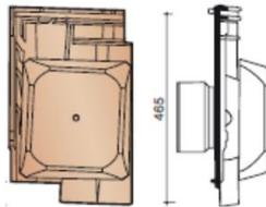
Проходной комплект для вентиляции (D=150мм)
