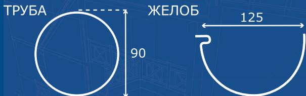
водосточные элементы Ruplast позволяют эффективно осуществлять сбор воды в объеме до 175 л/мин. или с площади до 150 кв.м в одну воронку.
